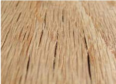
**MARCAS DE ASTILLA (CHIP MARKS):** Depresiones superficiales o sangrantes en o en la superficie de madera vestida provocados por afeitaciones o chips que se insertan en la superficie durante el vestir.
