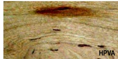
**MANCHAS DE PEGAMENTO (GLUE SPOTS):** La decoloración o la barrera para la penetración de acabado provocada por el sangrado a través de un pegamento desmontado sobre una superficie de madera expuesta o semiexpuesta.
