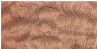
**FIGURA DE GRANO (GRAIN FIGURE):** El patrón producido en una superficie de madera por anillos de crecimiento anuales, rayas, nudos o desviaciones de grano natural, como grano entrelazado y ondulado y coloración irregular.
