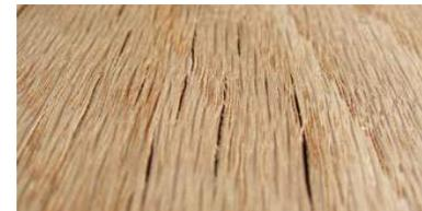
**GRANO VERTICAL (VERTICAL GRAIN):** Producido por corte perpendicular a los anillos de crecimiento de un tronco, donde la cara del miembro no es más de 45 grados a los anillos. Esto produce una agradable línea de grano recto. El grano vertical se define como si tuviera no menos de un promedio de cinco anillos de crecimiento por pulgada en su cara expuesta.
