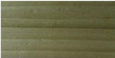
**MARCAS DE CUCHILLO (KNIFE MARKS):** Las impresiones o marcas de los cuchillos de la máquina en la superficie de madera vestida.
