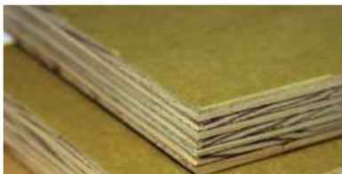
**SUPERPOSICIÓN DE DENSIDAD MEDIA (MDO) (MEDIUM DENSITY OVERLAY (MDO)):** Madera contrachapada de un núcleo de chapa fabricada con una superficie de fibra impregnada de resina termoendurecida unida a uno o ambos lados bajo calor y presión. MDO es especialmente adecuado para los acabados opacos (pintura); y la mayoría de las versiones son altamente resistentes a la humedad.
