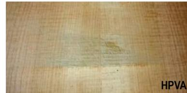
**MOTEAR (MOTTLE):** Parches ondulados rotos a través de la cara de la madera que dan la impresión de una superficie desigual, aunque lisa, provocada por un grano entrelazado retorcido con figura cruzada irregular, que es el acelerador. El efecto se debe a la luz reflejada en la distribución desigual de las fibras. Otros términos utilizados para describir las variaciones incluyen el ala de abeja, el violín, el pavo real, el ciruela, el ariete, el bloqueo o el freno del acelerador.
