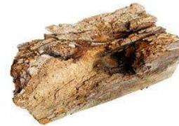
**DECOLORACIONES** (*DISCOLORATIONS*): Mantiene las sustancias de madera. Las manchas de chapa comunes son manchas de savia, manchas azules, manchas producidas por acción química causada por el hierro en la cuchilla de corte que entra en contacto con el ácido tánico de la madera, y las resultantes de la exposición de los extractivos naturales de madera al oxígeno y la luz, a la acción química de los tratamientos de las vetas o los componentes adhesivos, y/o al acabado superficial.
